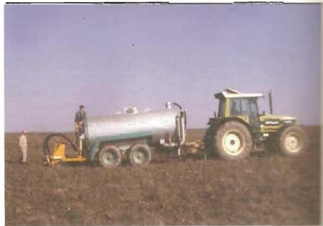
FIGURA 4 - Aspecto do injector em trabalho, agora injectando à máxima profundidade, mostrando o operador e o braço para aspirar a lama.
