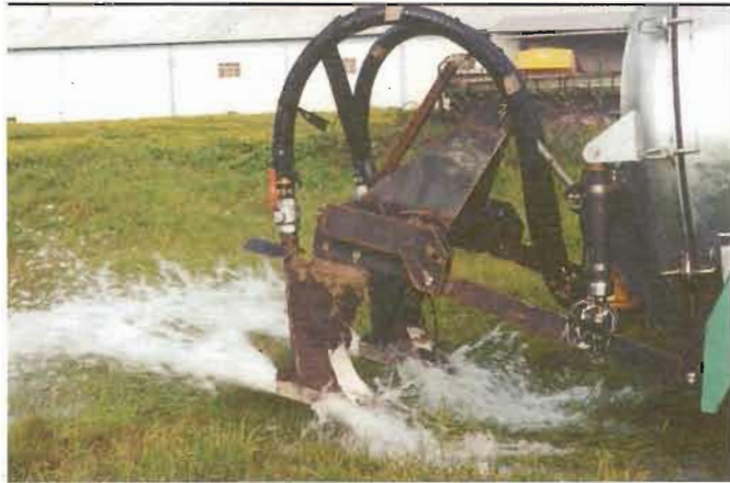
FIGURA 1 - Aspecto de pormenor do injector, com água para mostrar a forma de injeção.
